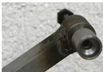
Figura 41 - Detalhe do acoplamento do eixo da bicicleta
