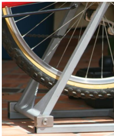
Figura 42 - Detalhe do mancal do eixo da frente
